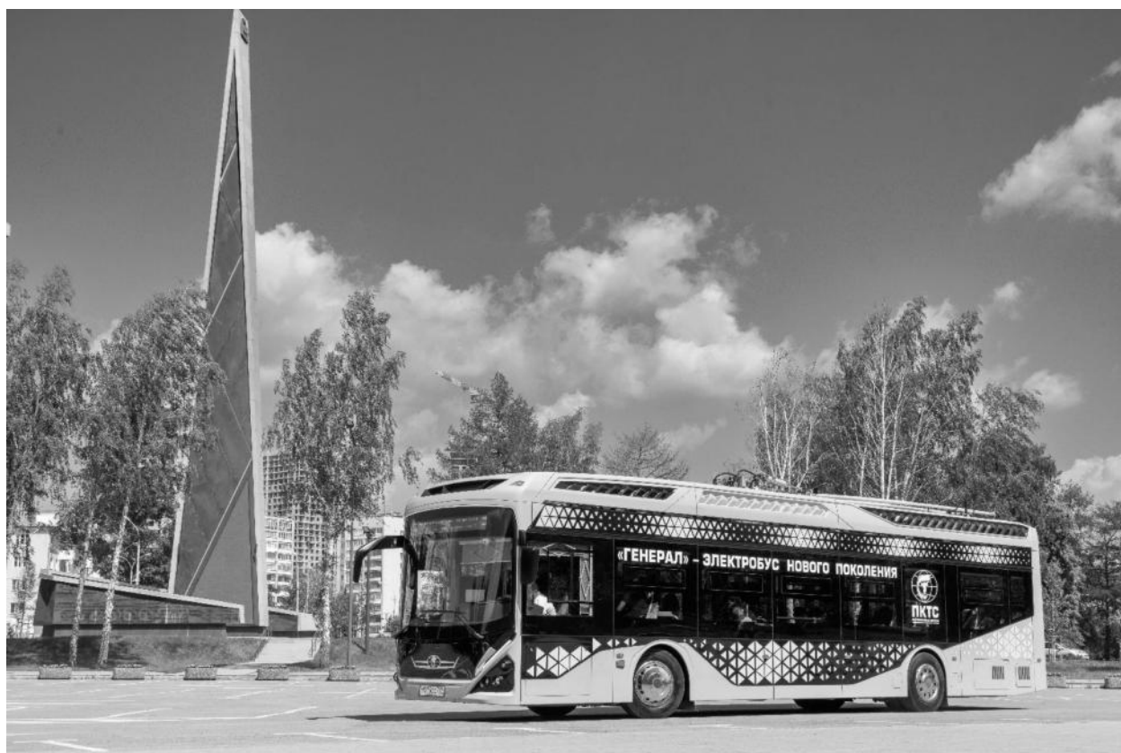
Рисунок 1.35 – Пример электробуса с универсальной функцией зарядки – статической от промышленной сети 380 В или 600 В и динамической зарядки от контактной сети троллейбуса 600В (ПКТС-62181 «Генерал») © ПК «Транспортные системы»
