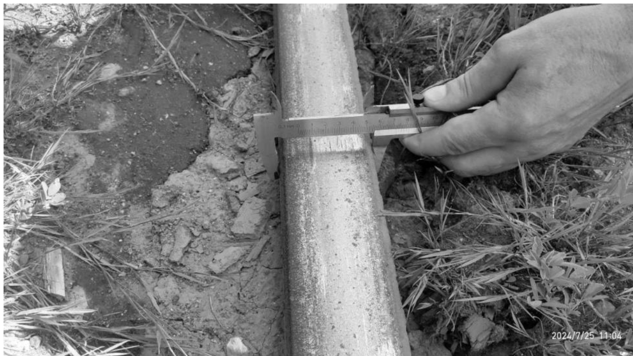
Рисунок 2.669 – Измерение ширины головки рельса при помощи штангенциркуля
