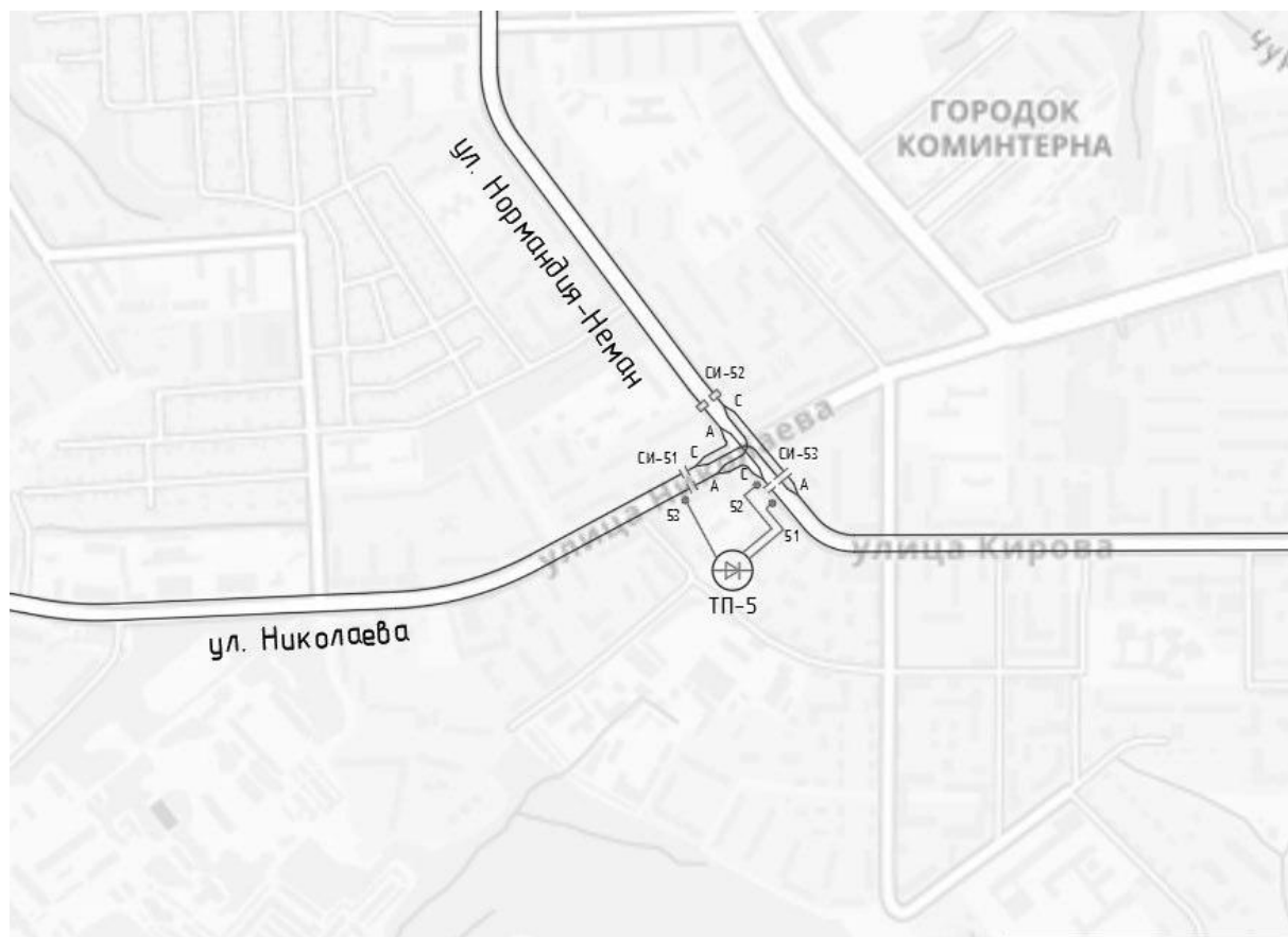
Рисунок 2.652 – Схема кабельных линий 600 В от ТП-5
