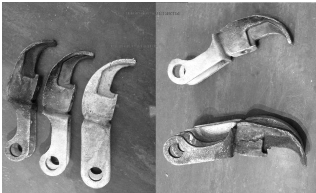
Рисунок 2.240 – Дугогасительный контакт выключателя ВАТ-43 (подвижная часть)
