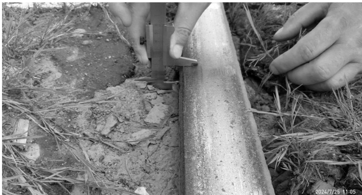
Рисунок 2.670 – Измерение высоты рельса при помощи штангенциркуля
