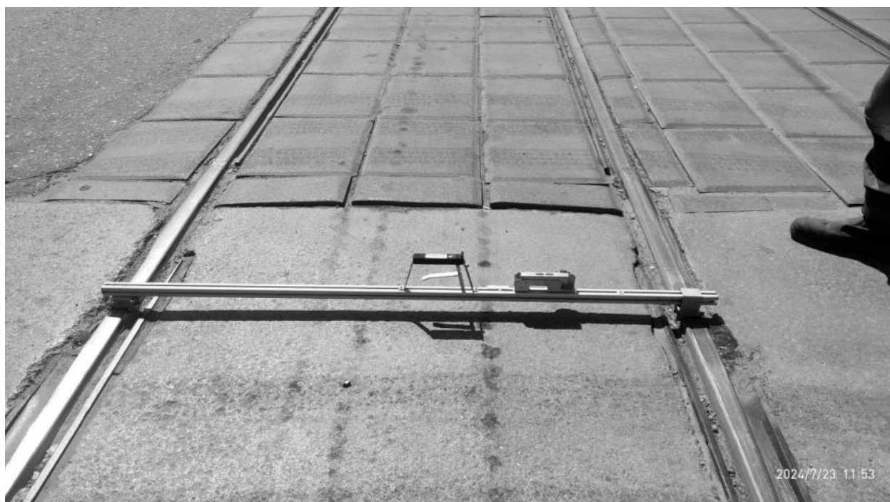
Рисунок 2.666 – Общий вид шаблона путевого ПШ-1520
