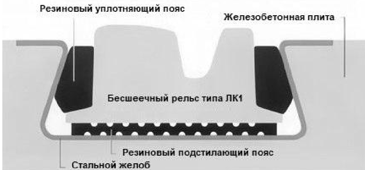
Рисунок 2.861 – Крепление рельса ЛК1 в стальном желобе плиты
