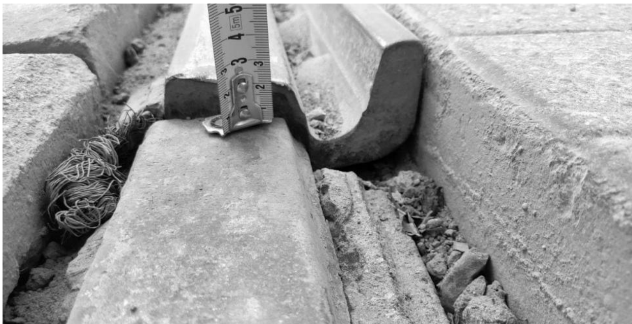
Рисунок 2.667 – Определение величины вертикального уступа рельсового стыка
