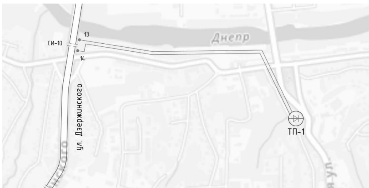
Рисунок 2.643 – Схема кабельных линий 600 В от ТП-1
