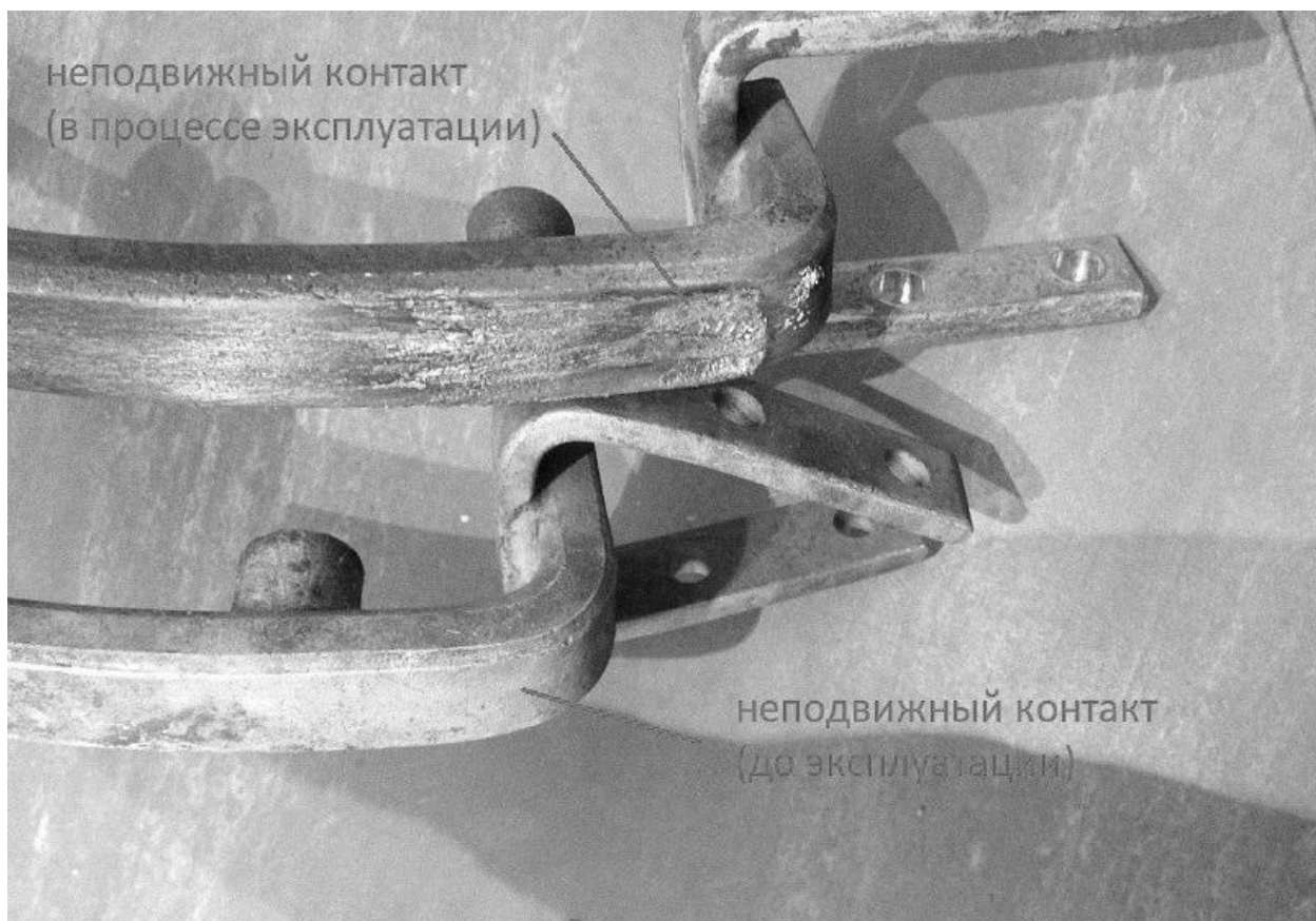
Рисунок 2.239 – Дугогасительный контакт выключателя ВАТ-43 (неподвижная часть)
