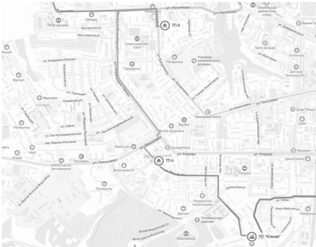
Рисунок 2.651 – Схема кабельных линий 6 кВ от ТП-5
