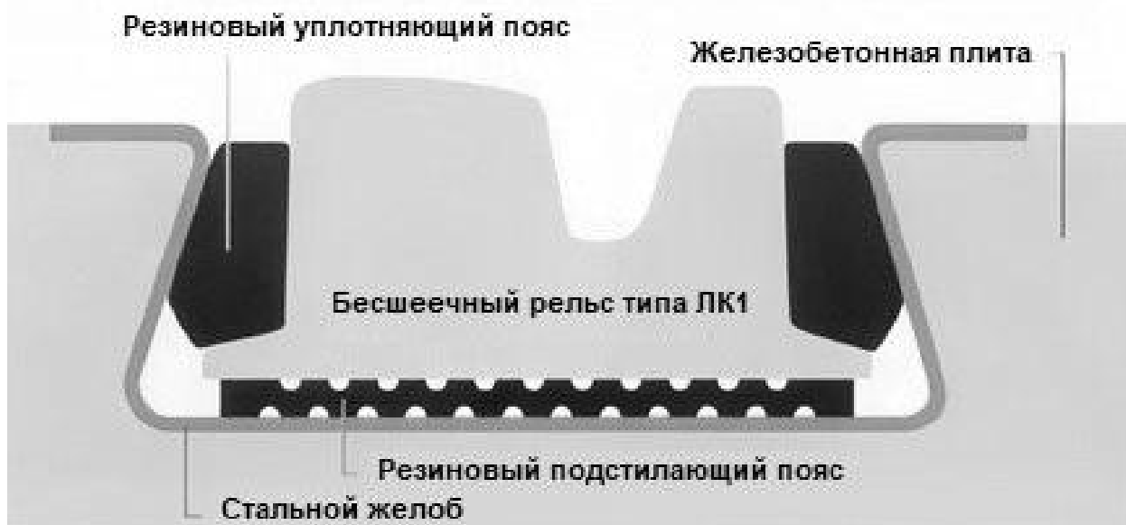
Рисунок 8.2 – Крепление рельса ЛК1 в стальном желобе плиты
