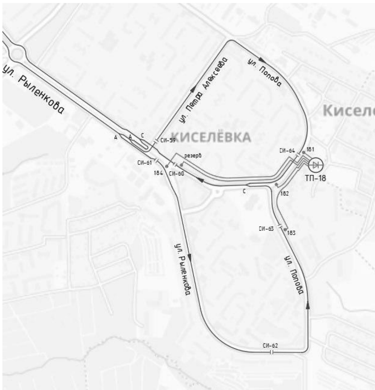
Рисунок 2.665 – Схема кабельных линий 600 В от ТП-18
