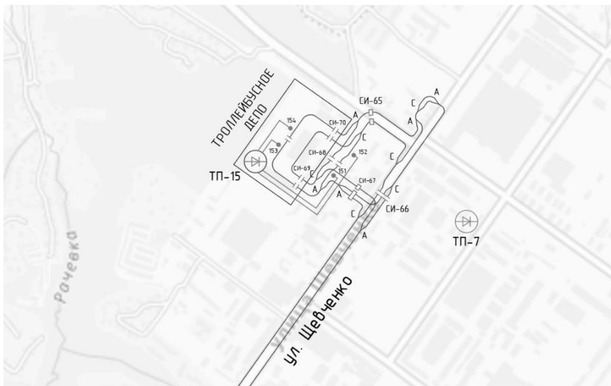
Рисунок 2.661 – Схема кабельных линий 600 В от ТП-15
