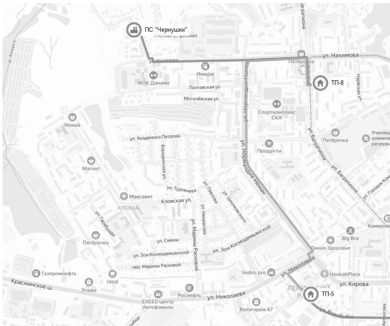
Рисунок 2.658 – Схема кабельных линий 6 кВ от ТП-8
